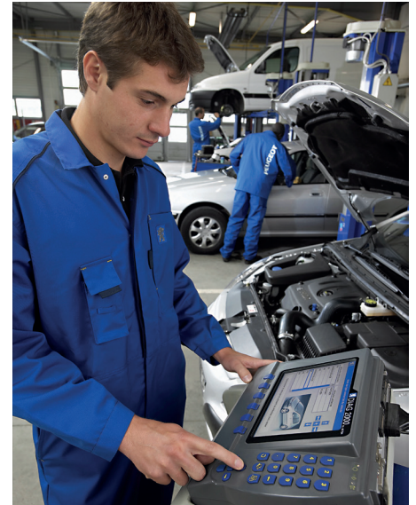
Die Werkstattarbeit mit Diagnosetester und Behebung von Softwarefehlern via Updates ist Alltag und setzt eine profunde Grund- und Weiterbildung voraus. Fotos: Peugeot/Hyundai
