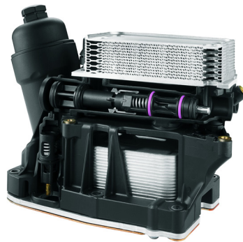
Das Öl filtern ist nur eine Aufgabe der komplexen Module. Auch die Kühlung und der Wärmeaustausch mit dem Kühlmittel sorgen für bessere Schmierleistung und geringeren Verschleiss. Foto: Mahle
