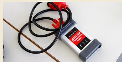
Der SAE-Standard J2534 beschreibt die Verbindung des OBD-Adapters. Die Hardware muss vom Automobilhersteller freigegeben werden, damit Diagnose oder Softwareupdates reibungslos möglich sind. Quelle: Se
