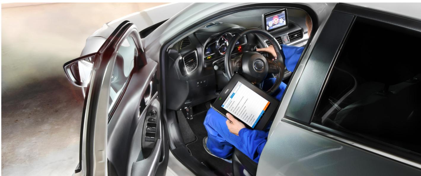
Die PassThru-Technologie ermöglicht auch mit einem markenunabhängigen Diagnosetester, modernste Steuergeräte-Updates durchzuführen. Das Prozedere für die Freischaltung durch die OEM ist jedoch aufwendig. Quelle: Texa
